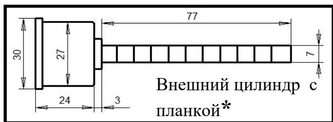
\*Планка внешнего цилиндра, предназначена для установки замка на двери различной толщины. Планку следует укоротить, до необходимой длины.
