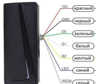
Для смены битности считывания с Wiegand 26 на Wiegand 34 необходимо в обесточенном состоянии соединить провод **WG34** и **GND**. Если этот провод не задействован - он должен быть надежно изолирован.
