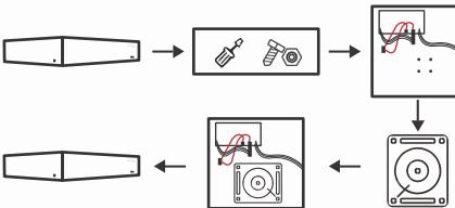
Пожалуйста, используйте специальный жёсткий диск SATA, рекомендованный производителем устройства. Перед установкой убедитесь, что питание выключено! Если есть стойка для жёстких дисков, сначала снимите стойку, установите жёсткий диск на стойку, подключите кабель питания жёсткого диска и кабель передачи данных, а затем установите стойку
