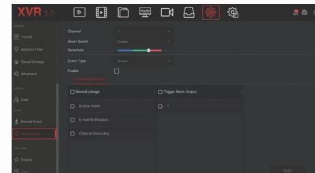
Шаг 2: Выберите режим Смарт события тревоги для настройки канала. Интеллектуальные сигналы тревоги событий, поддерживаемые устройством, включают в себя сравнение человека, поиск лица. Каждое интеллектуальное обнаружение может быть сконфигурировано с использованием различных методов обработки сигналов тревоги.
